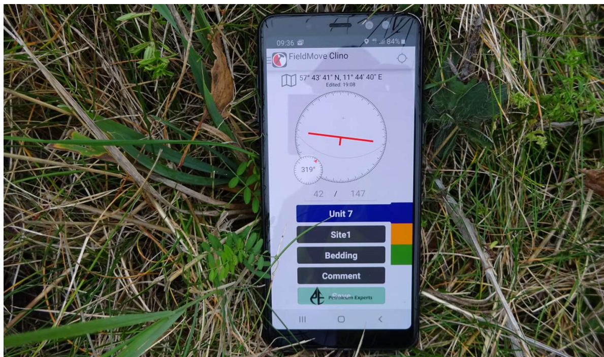
Bild 26 tagen på lutningen på slänten vid träpinnen och den är 42 grader vilket är relativt brant lokalt, men godkänt om det är sprängsten på ytligt berg. Framtida anläggning av ny infartsväg innebär att ingen åtgärd krävs i nuläget.
