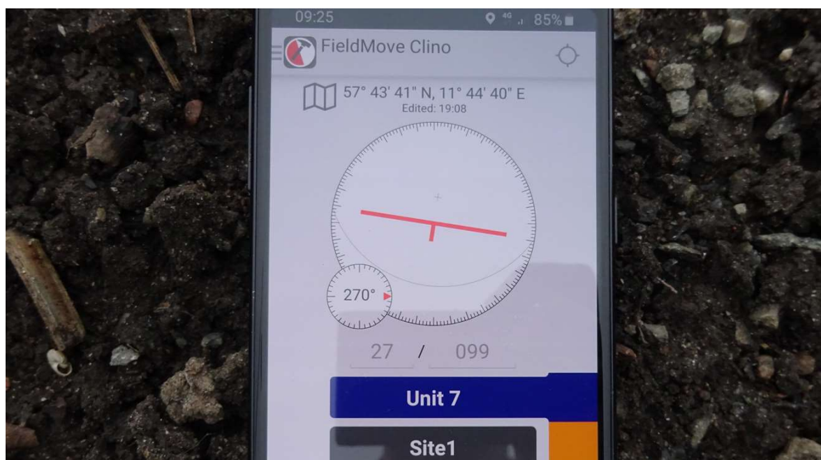
Bild 21 tagen på mätpinnens lutning som var som mest 27 grader vilket innebär att stabiliteten är godkänd med hänsyn till fyllnadsmassornas lutning.
